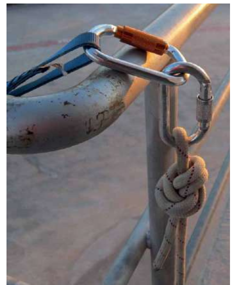
Mala colocación de mosquetones, el palanqueo puede evitarse colocando una cinta que prolongue el punto de encuentro entre los conectores.
