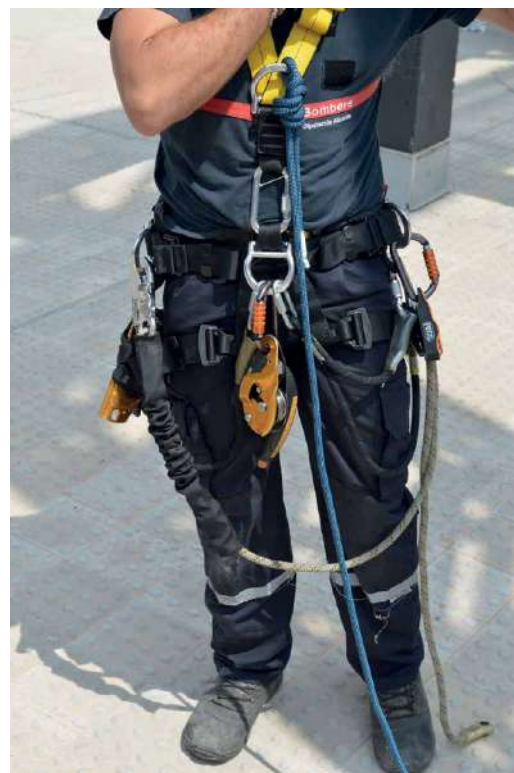
Conexión cuerda con anilla anticaídas mediante nudo de ocho o nueve por chicote.
