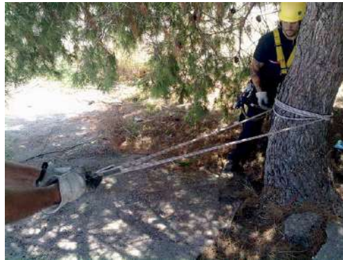
Ejemplo de desviador para evitar roces en un desmonte.
