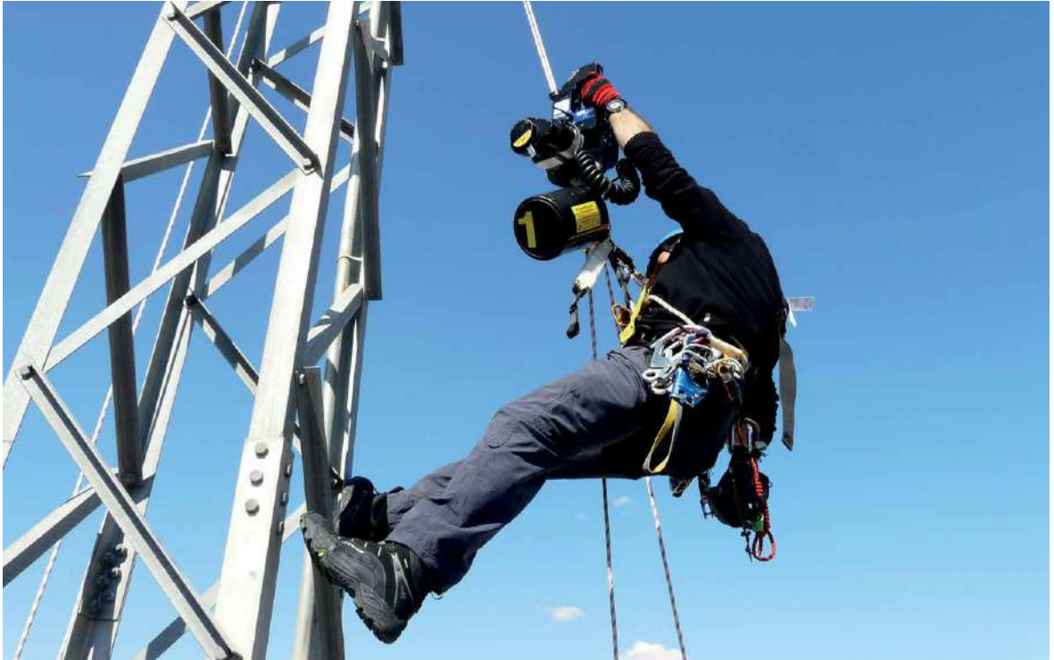
Motor eléctrico con certificación UNE-EN 341-A, adecuado para salvamento en intervenciones singulares.
