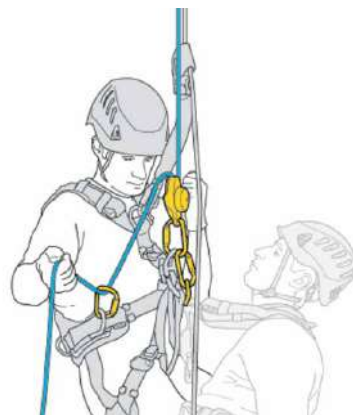
La maniobra de autosocorro descendente a plano inferior se facilita en gran medida con algunos dispositivos como ASAP e I´D de Petzl.
