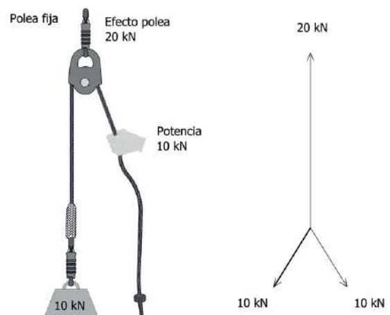
Polea fija sin ventaja mecánica.
