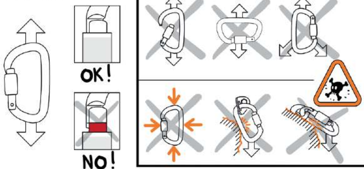
Izquierda ejemplo de mala colocación en conectores (fuente Petzl), derecha conector abierto.
