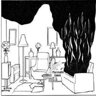
Figura 7 Desprendimiento de gases inflamables (pirólisis).
