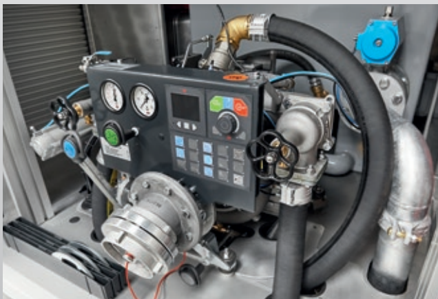
Montaje trasero: Ahorra espacio en la unidad trasera compacta. Todas las funciones necesarias están colocadas directamente sobre la bomba.
