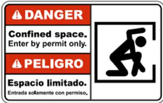
Figura 39. Señal bilingüe de peligro en espacios confinados (norma ANSI Z535.2-2011).
