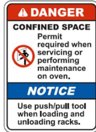
Figura 40. Ejemplo de señalización multirriesgo para espacios confinados (norma ANSI Z535.2-2011).
