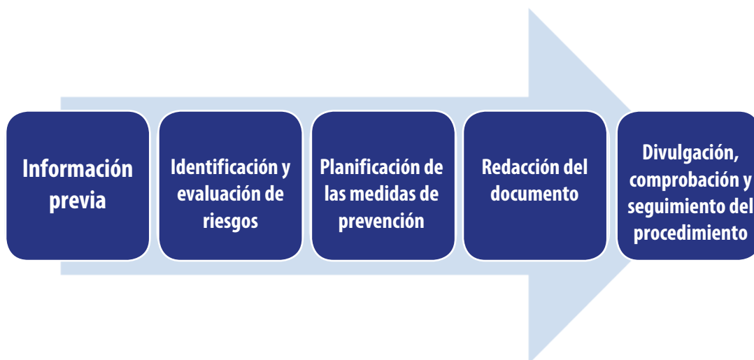
Figura 36. Método de elaboración de procedimientos de trabajo
