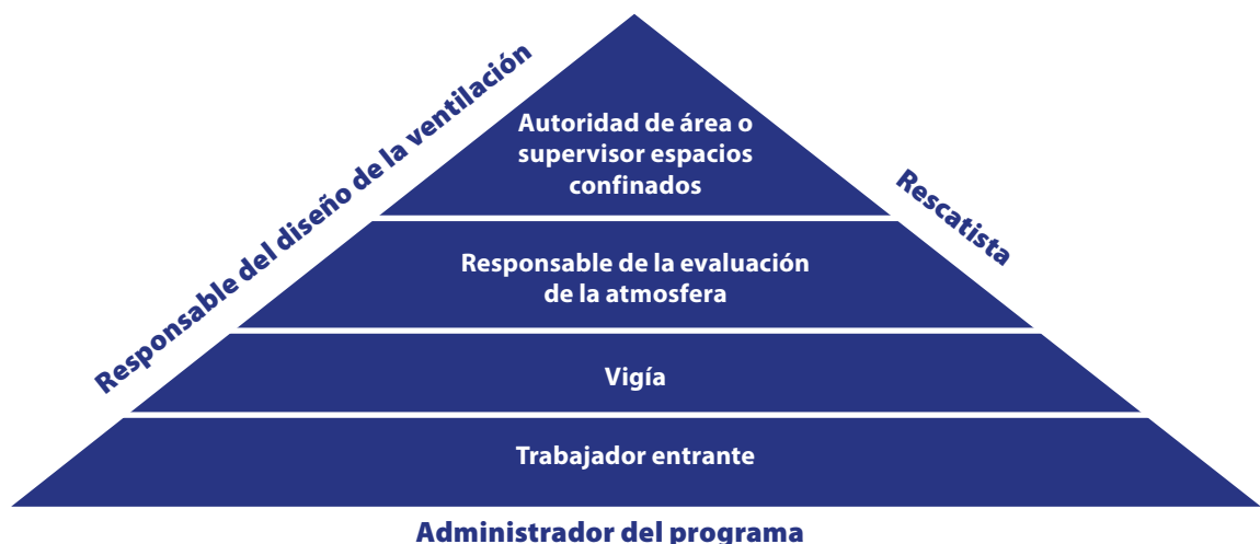
Figura 34. Roles mínimos en la implementación de un programa de gestión para espacios confinados
