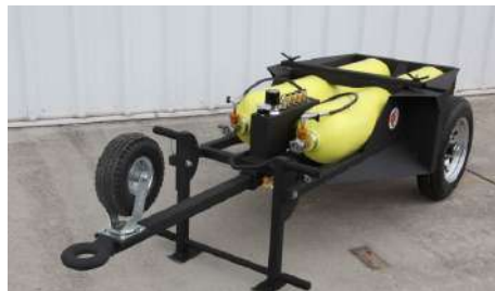
Figura 83. Carro para transporte de cilindros de aire respirable
