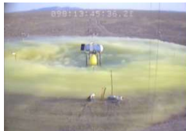
La parte más alejada del punto de fuga comienza a tener menor concentración de cloro y por tanto menos coloración, aunque su concentración puede seguir en umbrales tóxicos.
