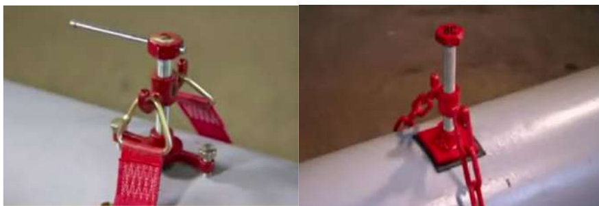
útil para taponamiento de fuga sobre el cuerpo del cilindro
