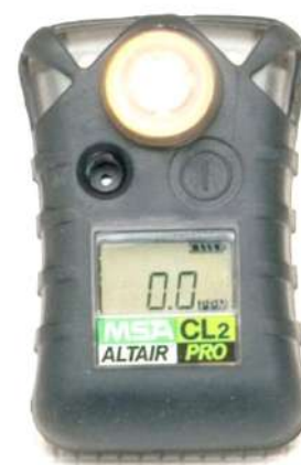
Detectormonogas de cloro MSA
