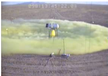
La dispersión del gas continúa de manera homogénea alrededor del tambor de cloro.
