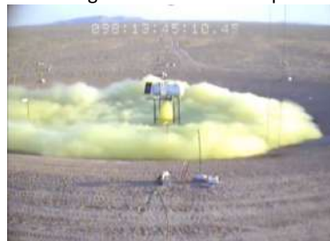
El gas comienza la dispersión de manera estabilizada y a ras de suelo debido a su mayor densidad respecto del aire
