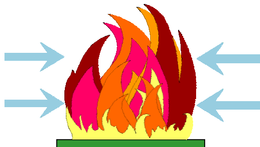
Figura 5.6 El aire entra desde todas las direcciones del compartimento
